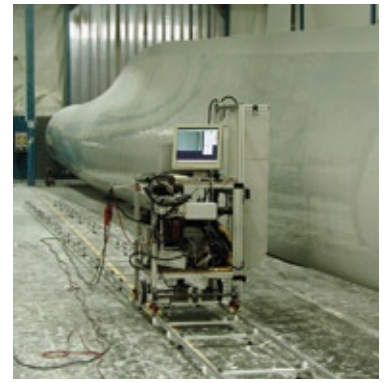
Messvorrichtung zur thermographischen Prüfung von Rotorblättern. Fraunhofer WKI.
